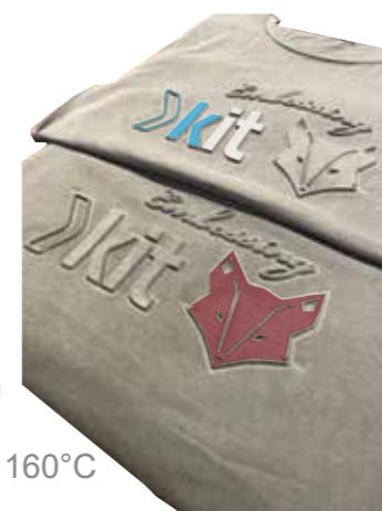
Haben sie die Möglichkeit das Textil in einen Ofen oder durch einen Durchlaufrockner laufen zu lassen, reichen bei 160°C auch 20 Sekunden Presszeit, wenn das Textil nach dem Pressvorgang für ca. 2,5 Minuten bei 160°C in oder durch einen Ofen laufen kann.
